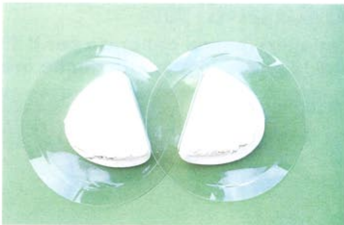
Fig. 13 - Termostampaggio del terzo ed ultimo disco
