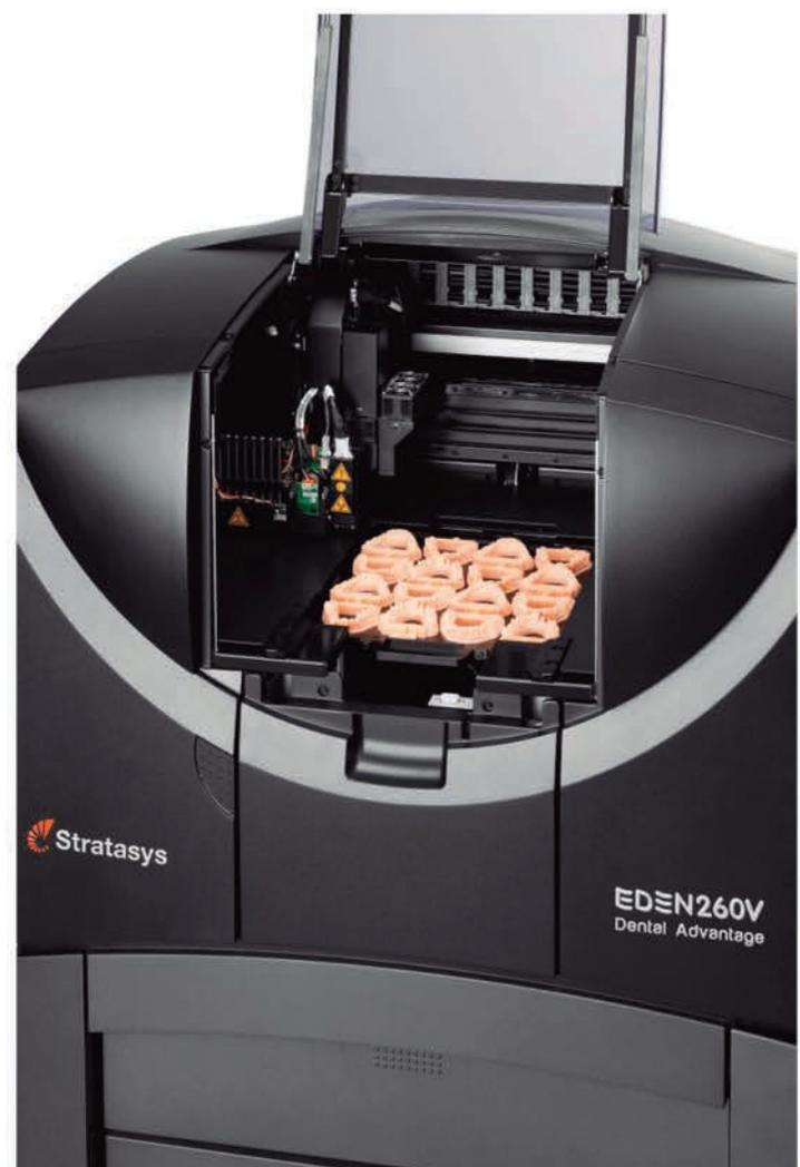
Fig. 07 - Máquina prototipadora de modelos 3D. (Modelo: Eden260V Dental Advantage
