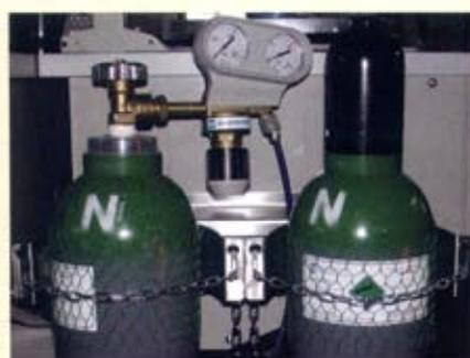
Fig. 10 bombole e riduttore di pressione del gas Argon
