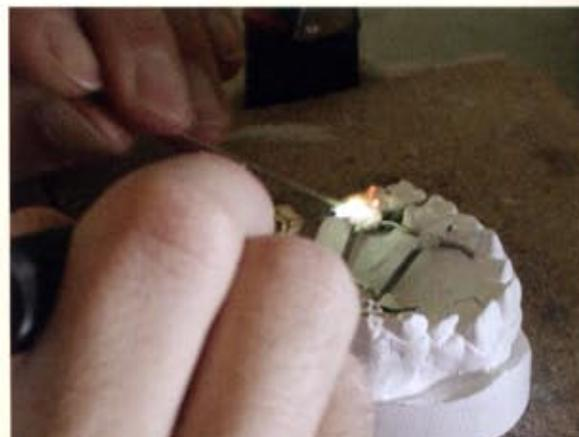
Fig. 2 Saldatura a fiamma con apporto di saldame a base di argento
