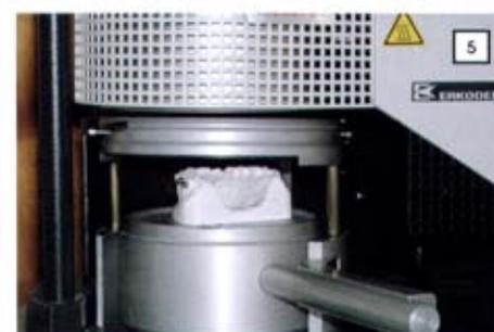
per il vuoto - es. Brega-, non hanno né il materiale adatto, né la capacità di termoformare in maniera dettagliata e precisa; basti pensare che la capacità di aspirazione di un disco verso il modello è di circa 0,8 atm rispetto al soffiaggio a pressione verso il basso dell'altra macchina che è pari a 6 atm: ben otto volte superiore. Si colloca quindi il modello nella muffola (5) e si procede
