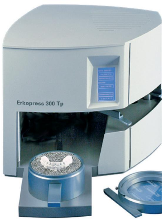
**8. Modello posizionato nella macchina per termoformatura a pressione.**
