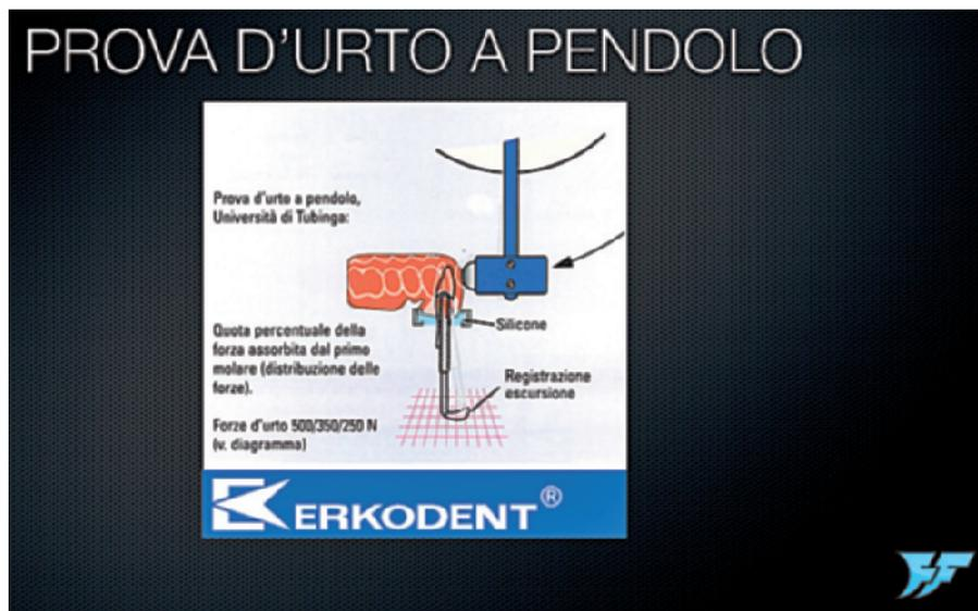
2. Visione schematica della prova d'urto a pendolo dell'Università di Tubinga.
